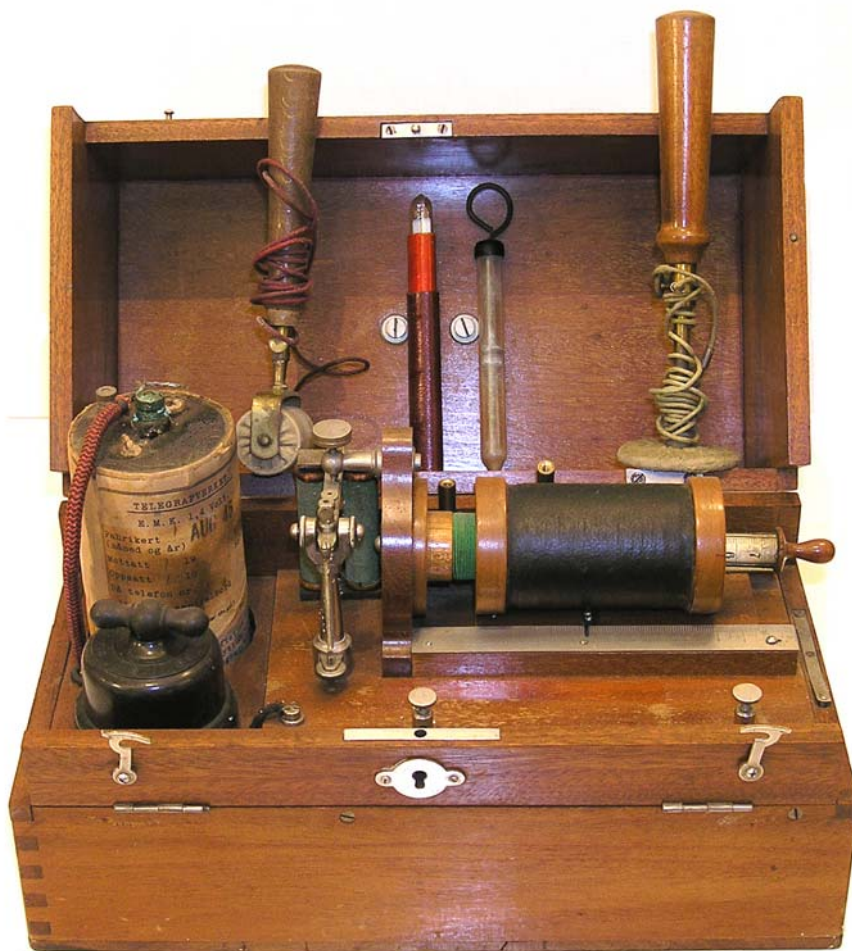
Et noe større apparat for tørrelement drift, antakelig fra rundt 1915. En kan bevege kjernen i spolen for å variere induktansen. Metallektroder benyttes.
