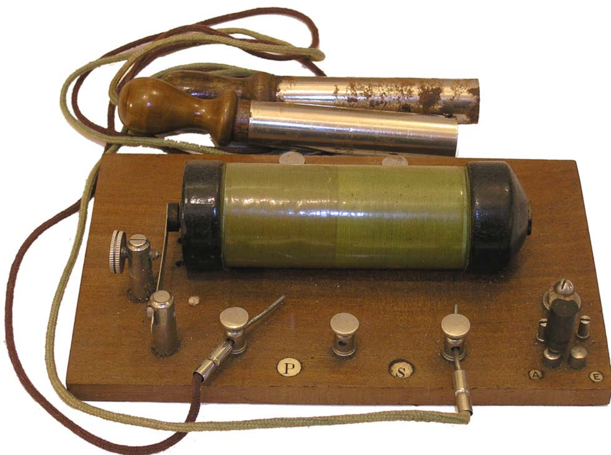
Det minste apparatet jeg har, fra ca 1920. En treplate med spole, vibrator og to enkle metallektroder. Ikke noe særlig effekt fra dette lille apparatet.
