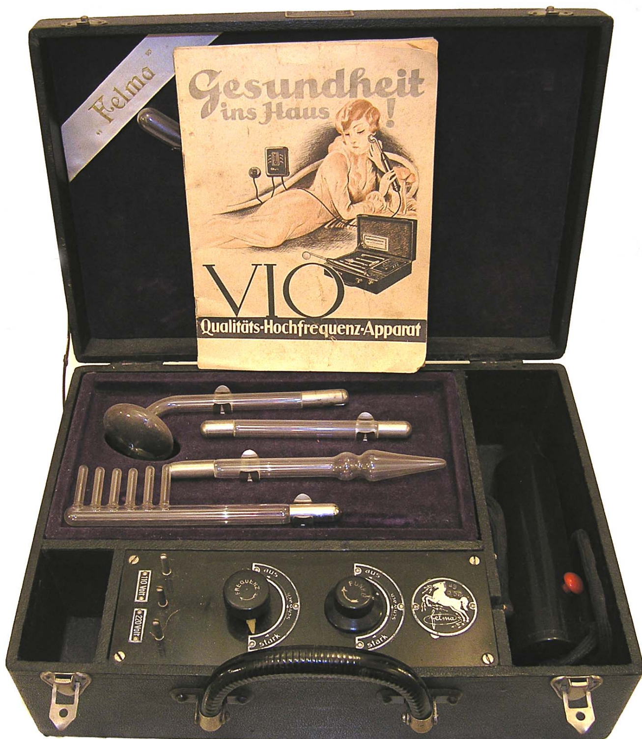
Et typisk lysnettdrevet apparat fra slutten? av 1920 tallet, til bruk i hjemmet. Som elektroder brukes evakuerte glasskolber av forskjellig utførelse. Regulerbar intensitet/frekvens og frisk høyspenning.
