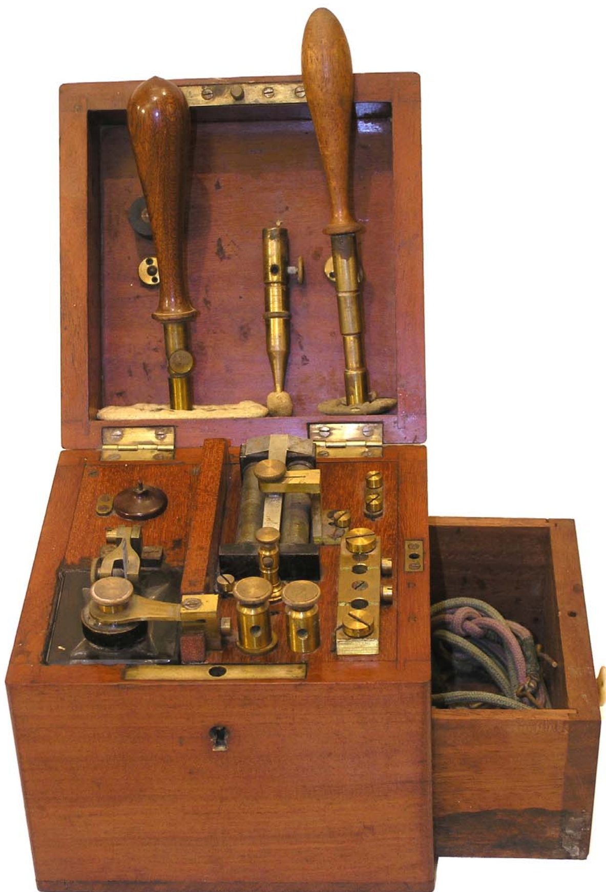
Et lite elegant apparat i treverk og messing, med innbygget blyakkumulator, antakelig fra ca 1890 åra. Metallelektroder benyttes.
