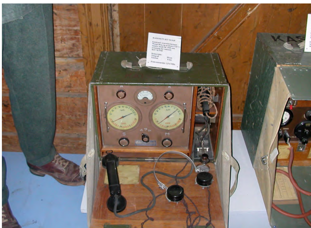
Radiosett KST M/1939. Frekvensområde 2.5 - 4 MHz
