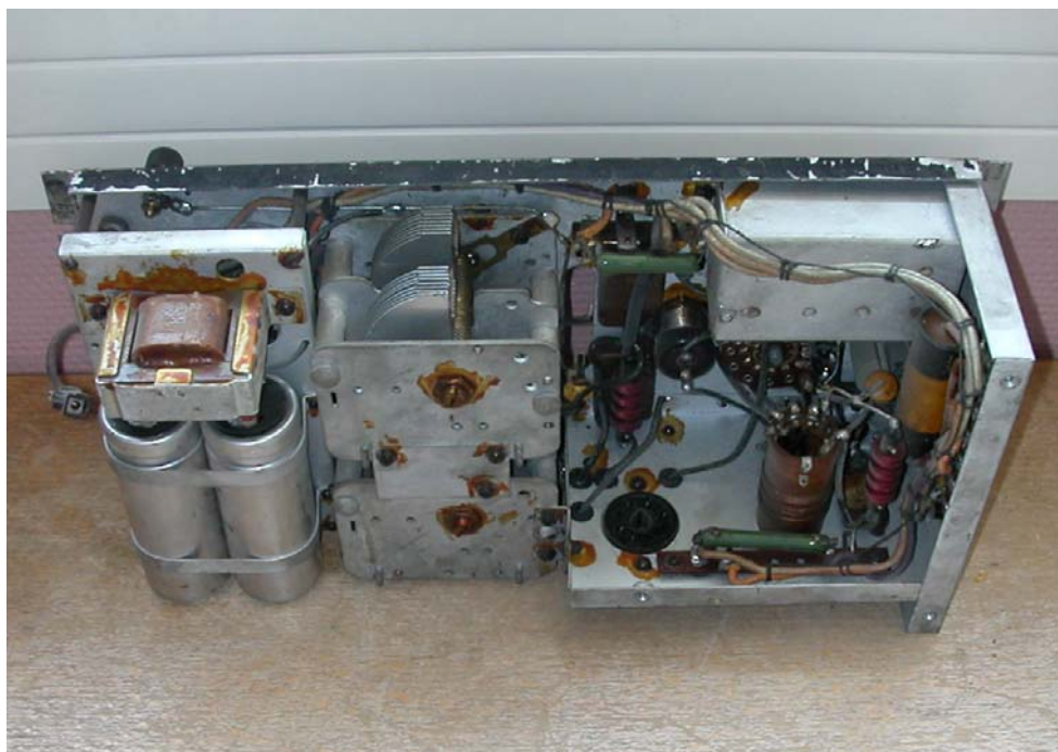
Senderdelen av 3MkI. Røret, 6L6 mangler. (Foto: LA3BI)
