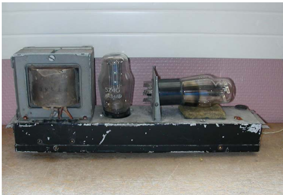
Nettpowersupply til 3MkI. (Foto: LA3BI)
