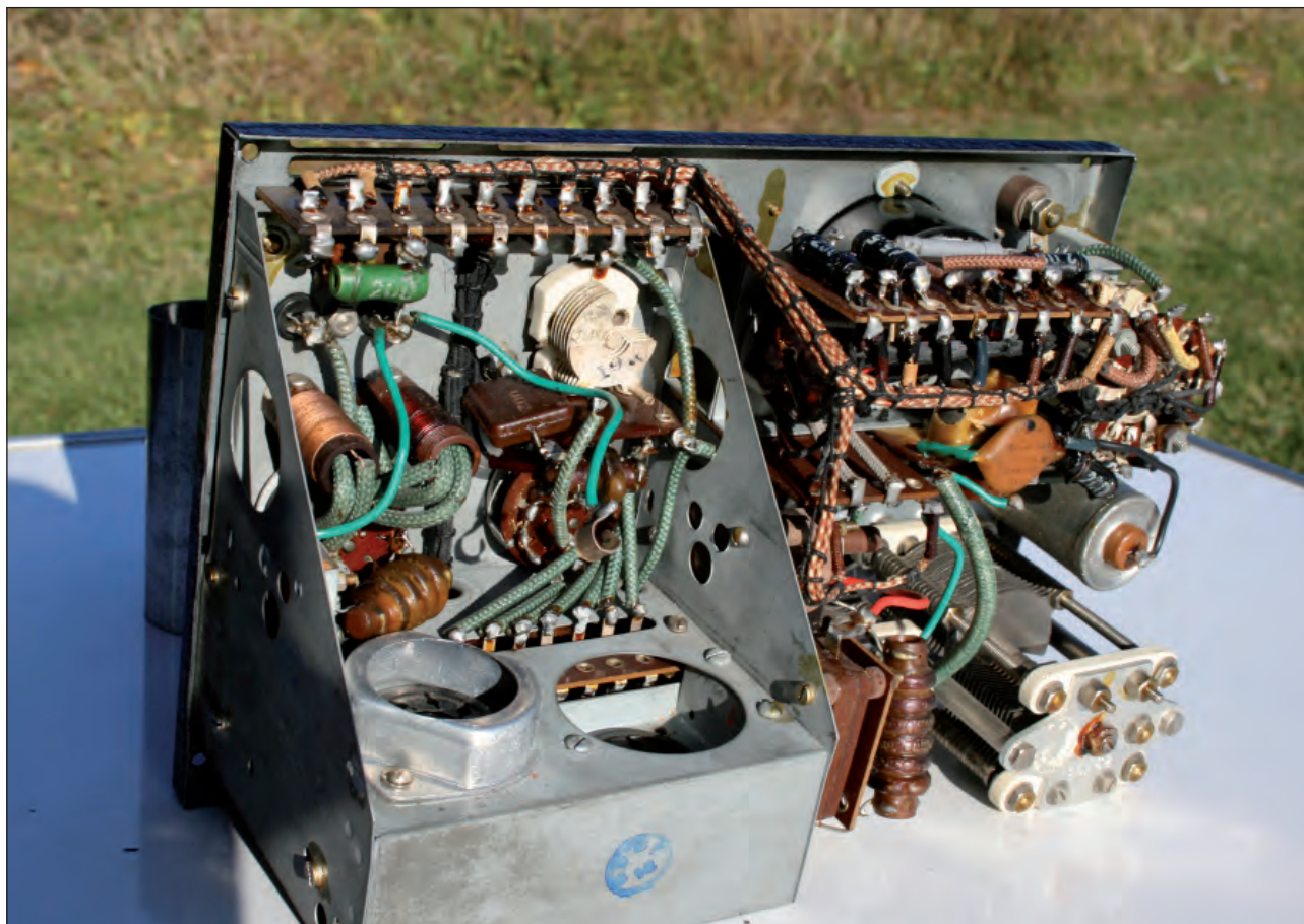
De to rørene er tatt ut. (Foto 6)
