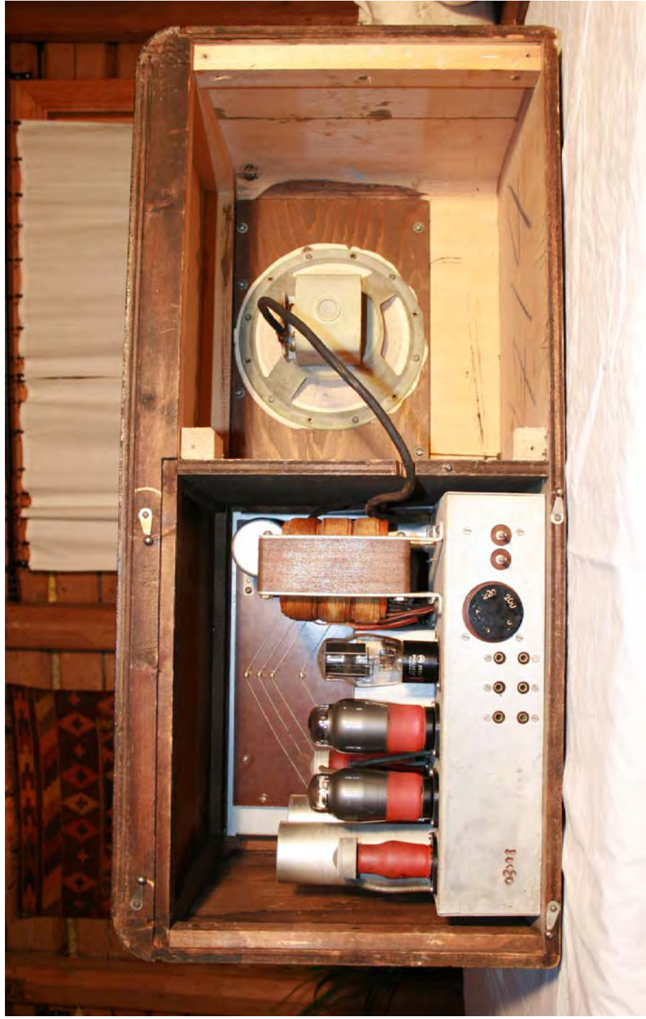
Huldraen sett bakfra. Legg merke til den lille elektrodynamiske høyttaleren.
