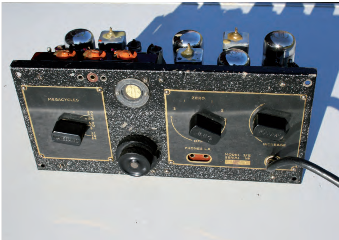
Mottakerdelen. Den har samme tuningknapp som Sweetheart (og WS19 Mk3). (Foto 9)
