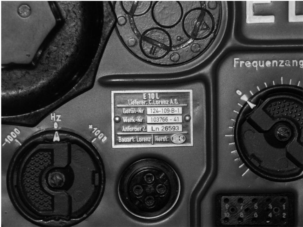
Bild 4: FuG10 EL typskylt I bildens överkant syns
