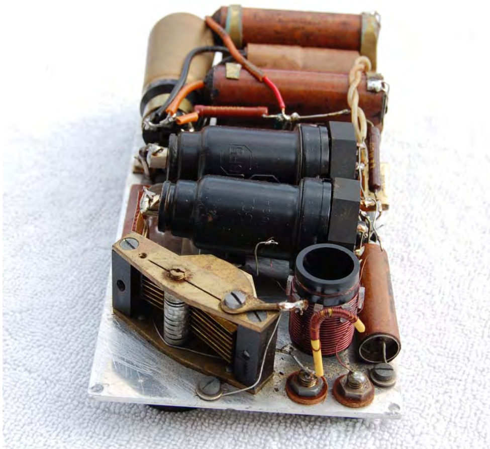
"Kongshavneren" med pentodene har illegalt produserte dreiekondensatorer.
