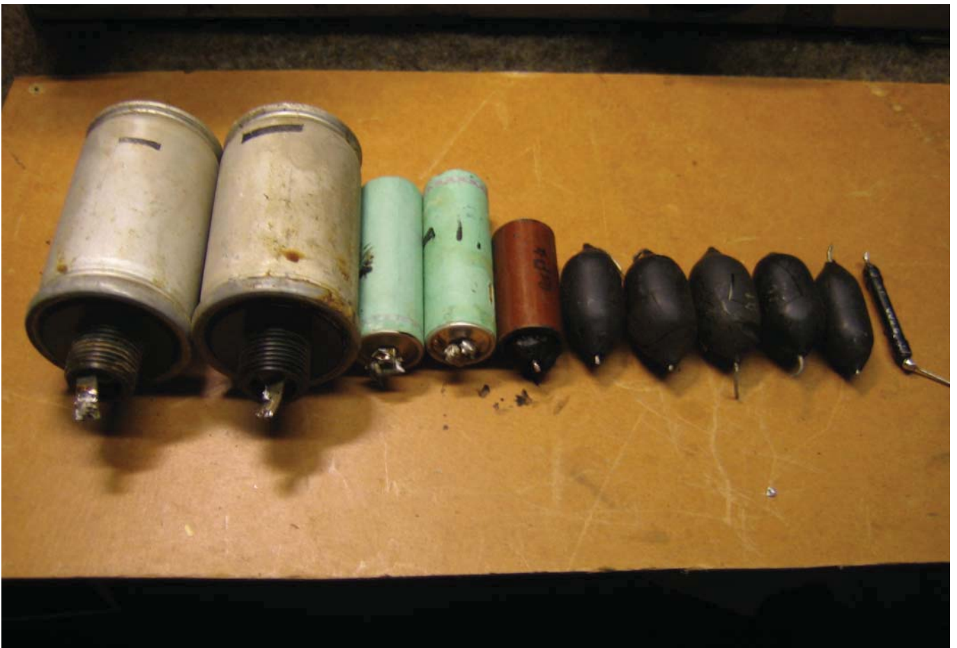
Øverst: skaladrev, nederst: utskiftede kondensatorer.
