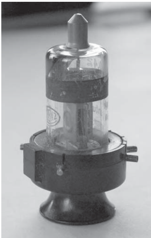
Dette spesielle røret heter RL2,4 P2 og kunne brukes som både sender- og mottakerrør.
