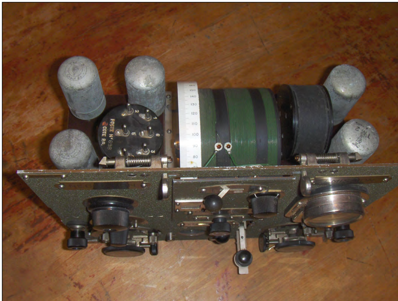
ER15 sett ovenfra. Legg merke til den innebyggede morsenøkkelen.
