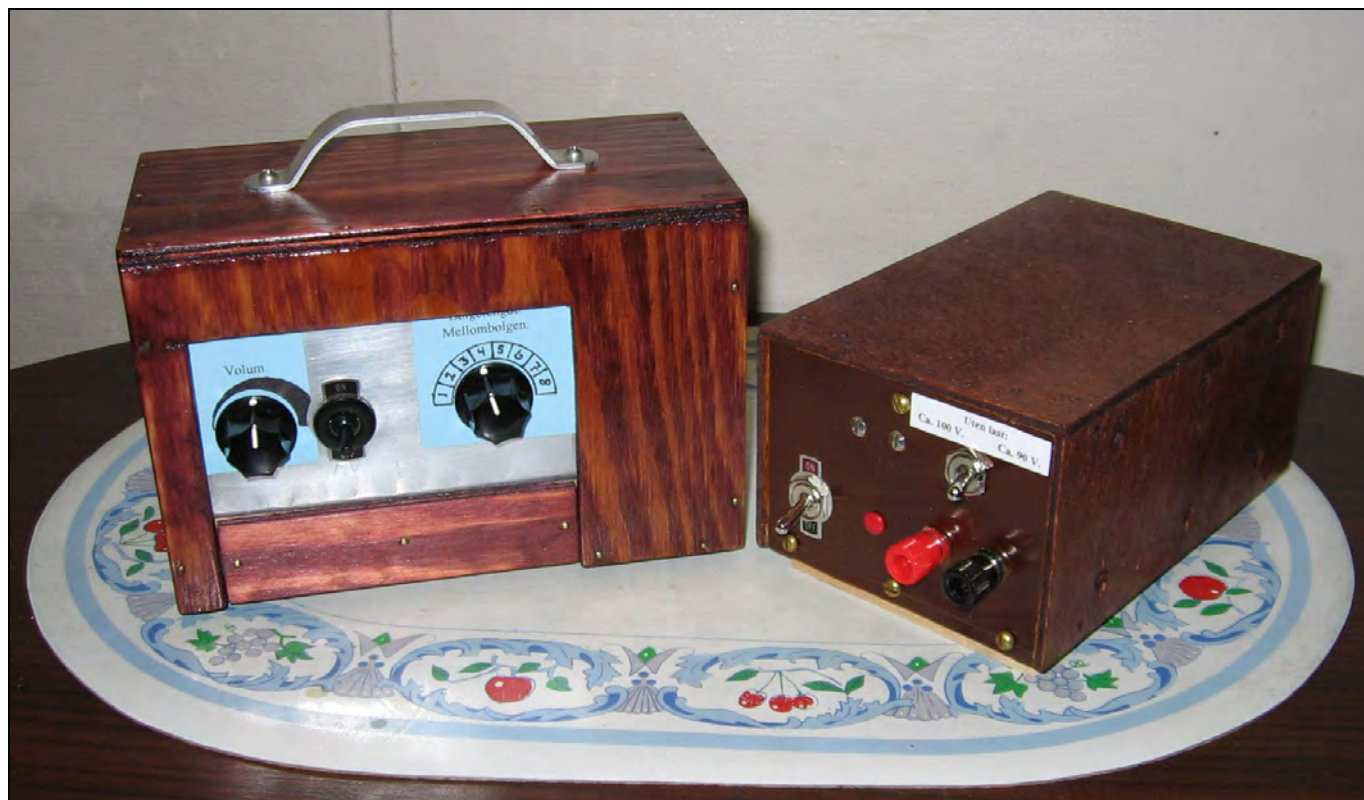
Den hjemmebygde mellombølgesender med kraftforsyning.
