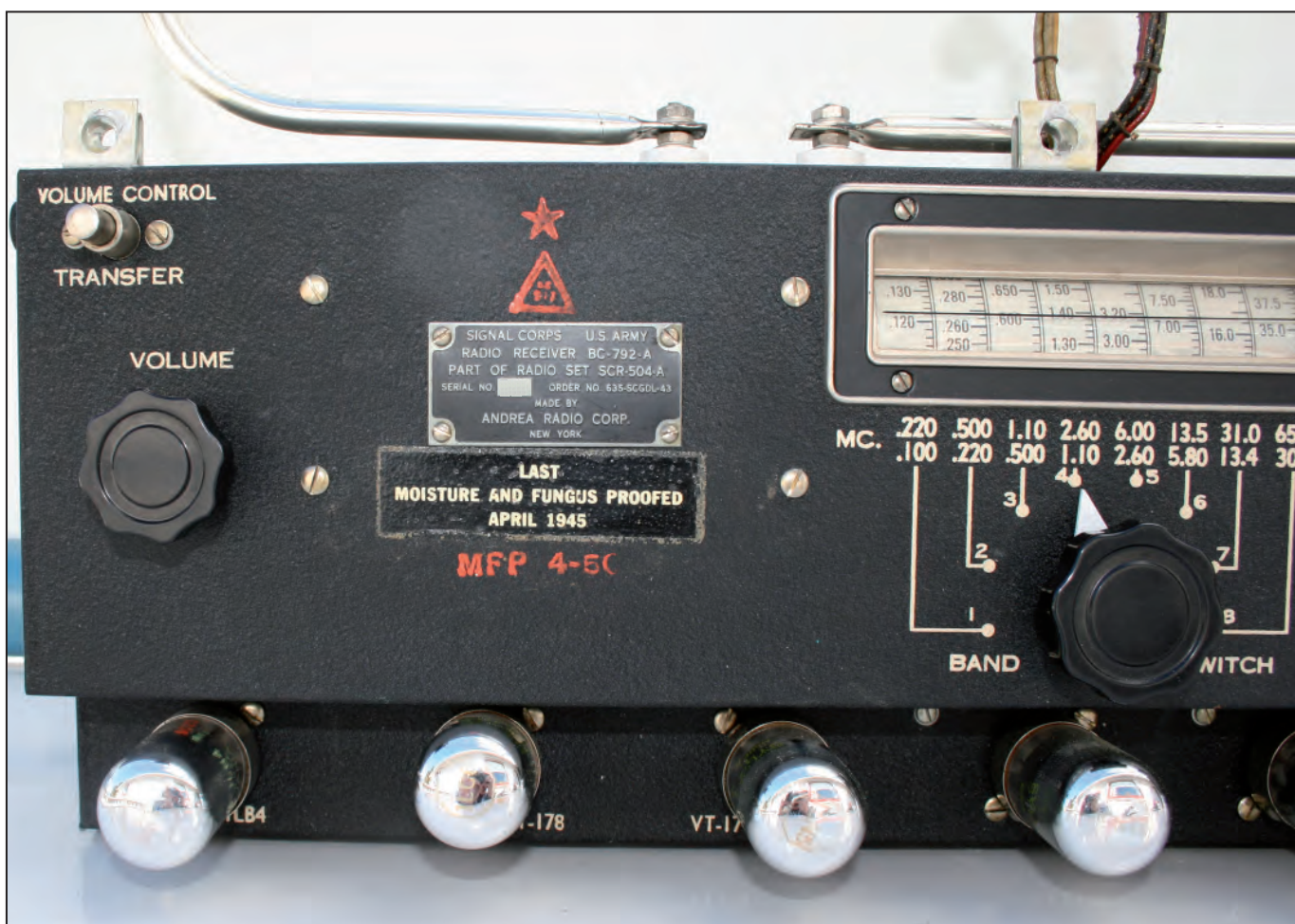
Skiltet som tydelig viser apparatets korrekte betegnelse, samt rødt stempel: MFP 4-50 (Moisture and Fungus Proofed April 1950)
