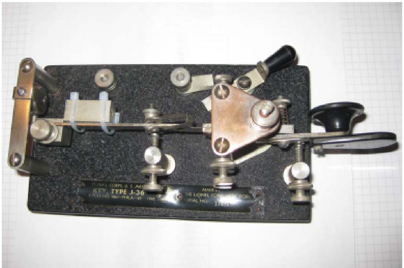
US militær nøkkel type J-36 laget av The Lionel Corp i 1942. Modellen er en Vibroplex. (Foto: Leif Persson 2492/SM7NCT)
