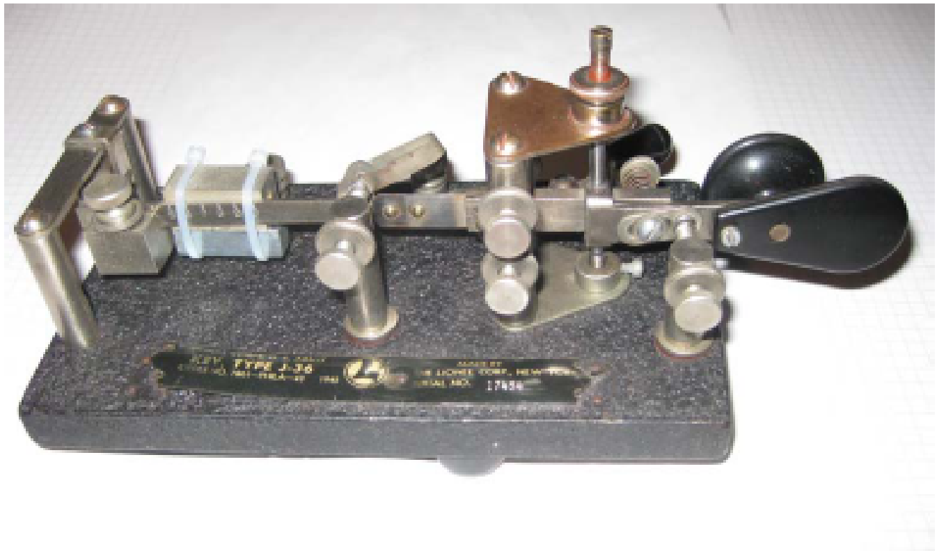
US militær nøkkel type J-36 laget av The Lionel Corp i 1942. Modellen er en Vibroplex. (Foto: Leif Persson 2492/SM7NCT)
