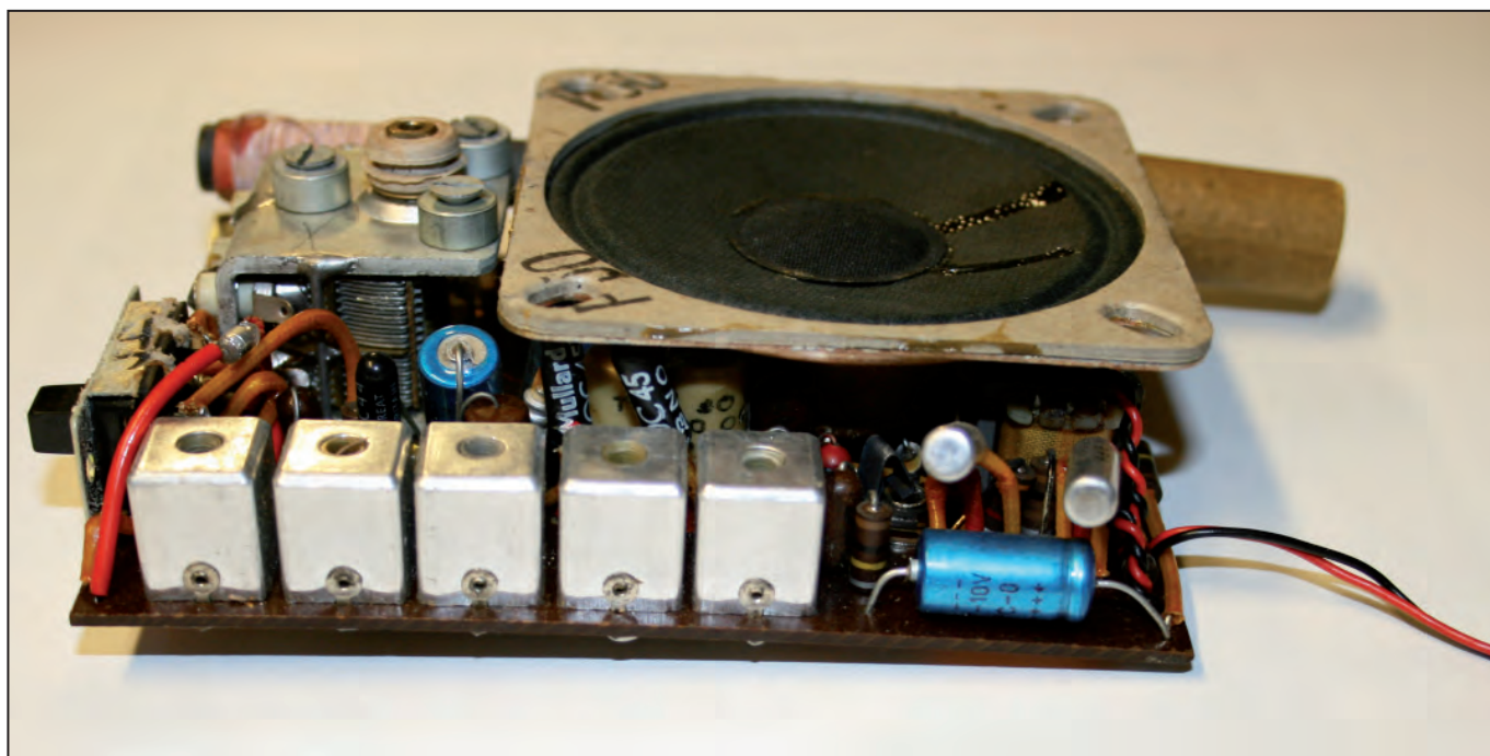
Legg merke til transistorene OC44 og OC45. (Blander og mf-forst.)
