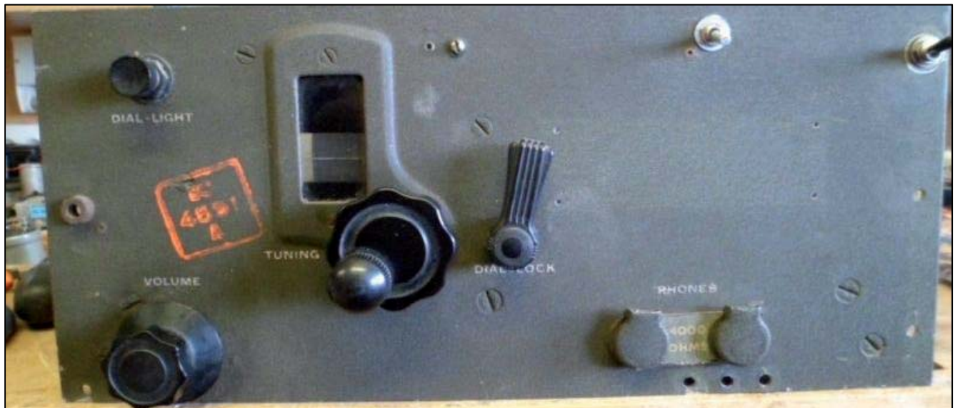
Mottakeren: To små brytere er brukt i stedet for en dreievender.
