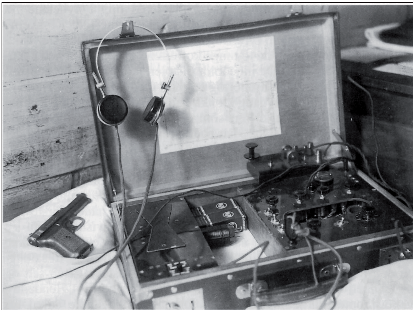
Agentsettet MkVI D fra Tomstads loft. Pistolen er en Mauser Pocket 1910 kaliber 32 ACP.
