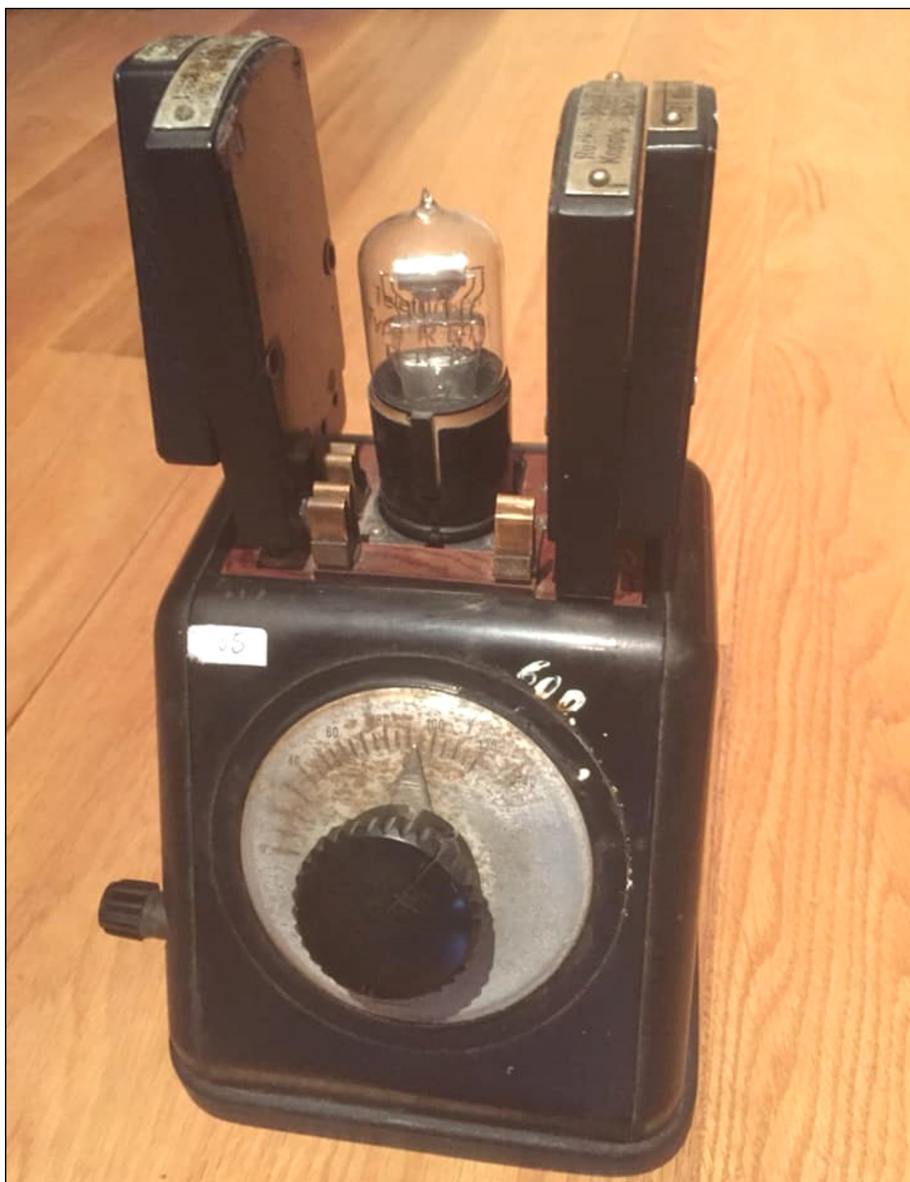
Telefunken skipsmottaker fra 1921 type Telefunken E266 med røret RE11 (Foto: Ragnar Tellefsen)
