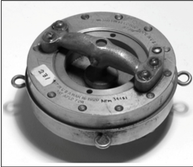
Kullkornmikrofon fra Western Electric. US.Pat. 1.546.749A-2
