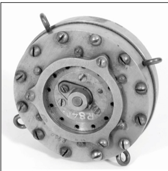
Kondensatormikrofon fra Western Electric. US.Pat. 1.333.744A
