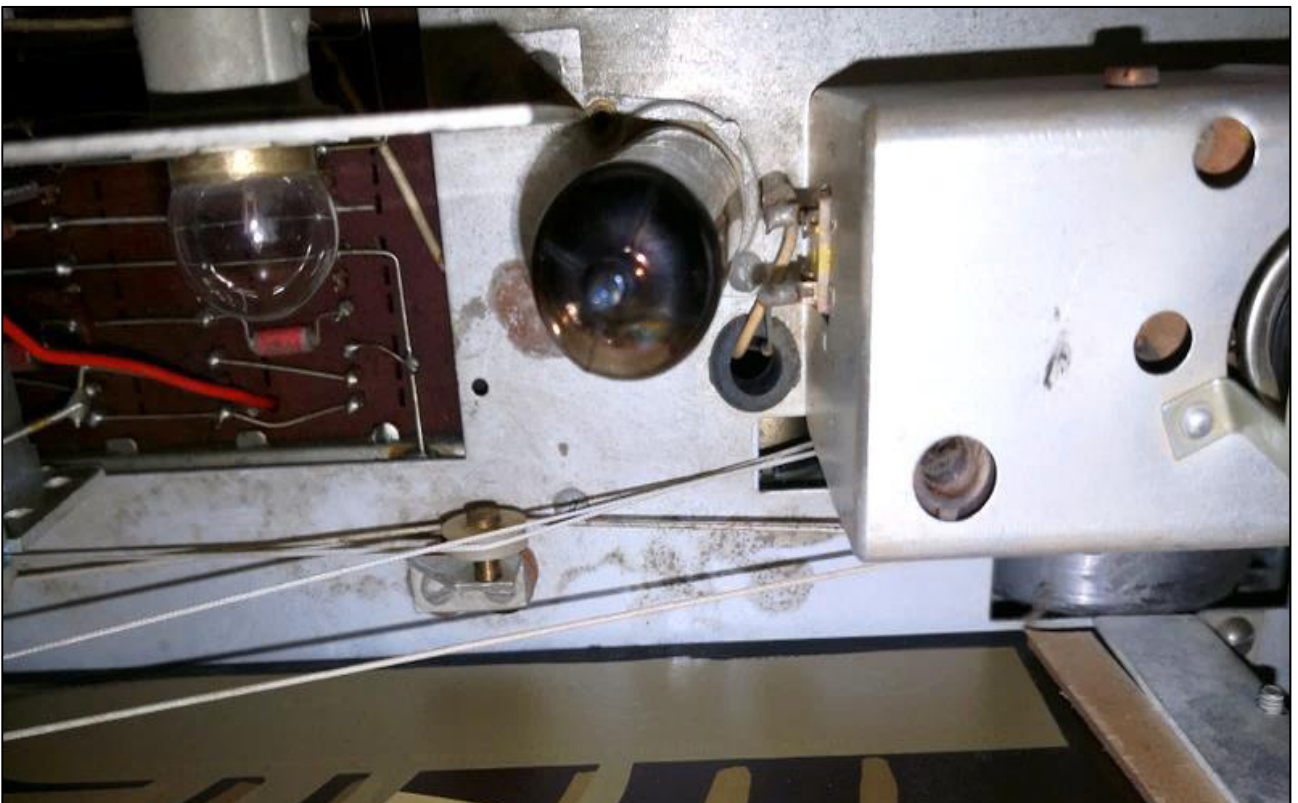
Snorttrekk systemet for FM tuner. Ganske oversiktlig men litt vrient å finne ut av hvis snora skulle være røket. Nesten tilsvarende på undersiden for ferritt antenna.
