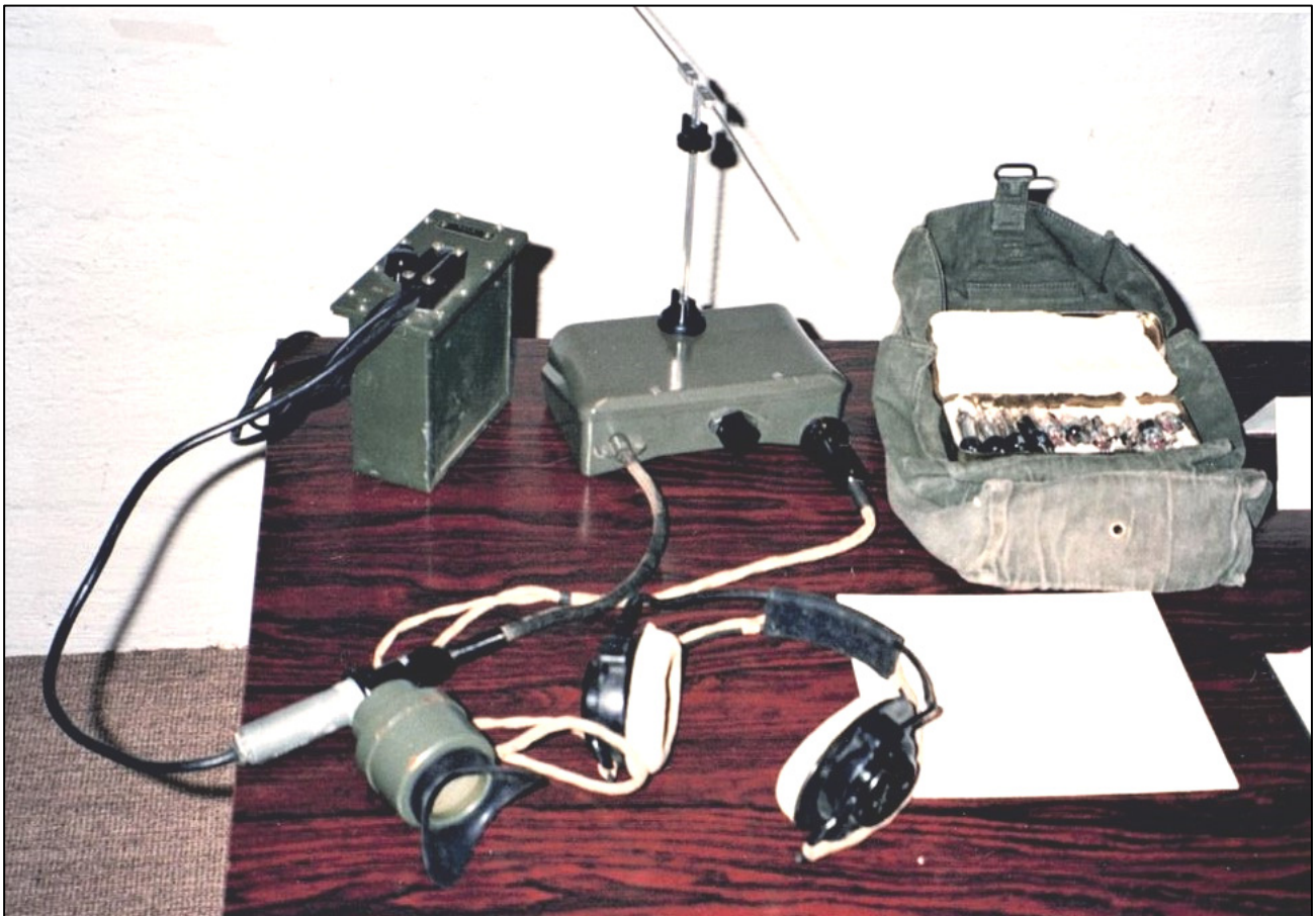
S-PHONE, UHF sender/mottaker for kommunikasjon mellom transportfly og slipp-gjeng på bakken under 2VK.(Fra seminaret med John Brown den 15.10.1988)
