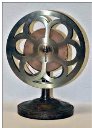
Morsepapirstrimmelhjul Frittstående papirstrimmel-hjul for morseskriver. (Foto: T. M. Namsos)
