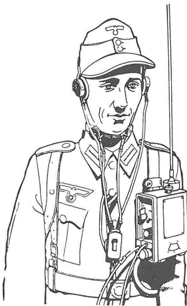
Fig. 4. Bæremåten for radiosettet med strupemikrofon og høretelefoner.
