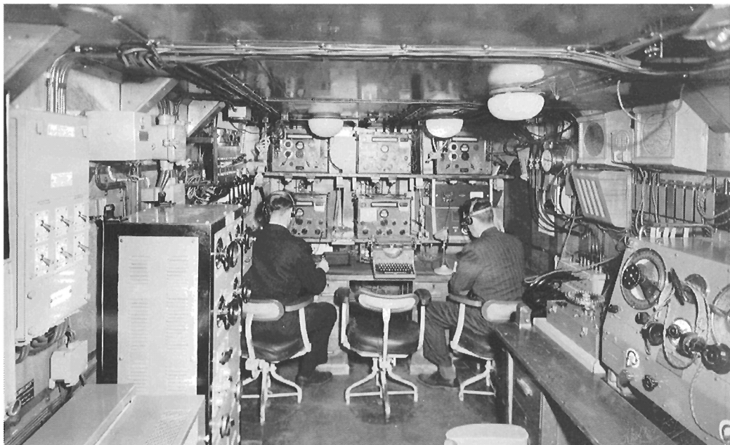
Fra radiatorommet: En vegg full av Marconimottakere.
