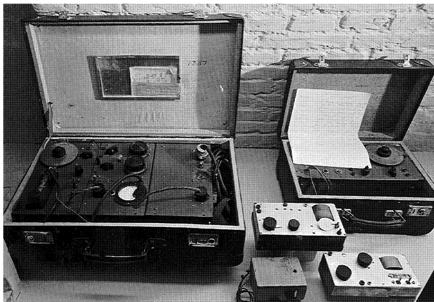
Et bilde fra Norges hjemmefrontmuseum som viser OLGA, LISBETH, to varianter av KONGSHAVNEREN og en 1-rørs mottaker som også ble laget i et visst antall. I tillegg til Olga-settet har vi her de eneste serieproduserte illegale mottakere bygget i Norge under krigen.
