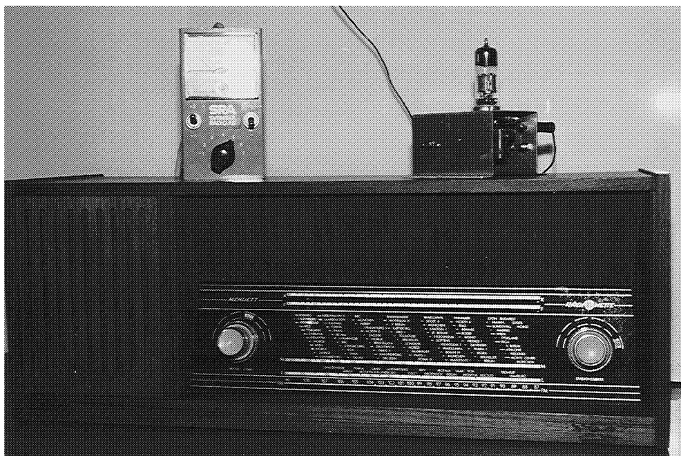
Fig4. Langbølgesenderen og VU-meter tilkoblet en Radionette Menuett
