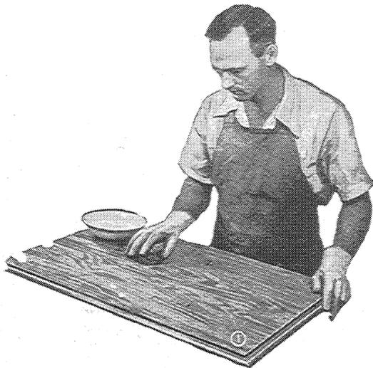
Fig. 1. Efter at træet er pudset grundigt, vandes det ud flere gange og slibes efter med finere og finere sandpapir.
