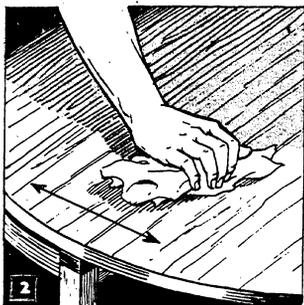
Fig. 2. Indgning med vaselinolie fremhæver strukturen og giver træet en varm, dyb tone. Olien gnides omhyggeligt på og skal derefter tørre i et døgn.
