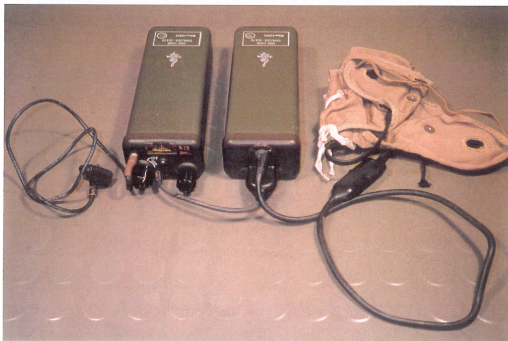
RBZ-mottakeren, en "kraftig" superhet laget av Emerson Radio i USA for illegal kortbølgetyting (foto Erling Langemyr)
