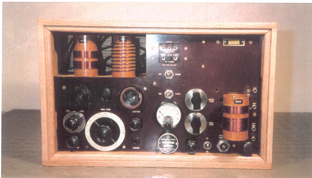
Agentsett Mk V, brukt av SIS. Settet på bildet har nylaget kasse. (foto: Erling Langemyr)
