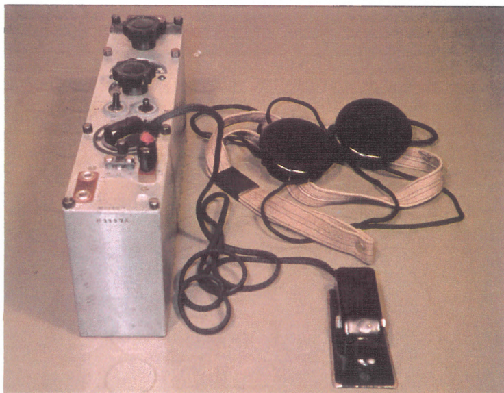
Finsk patruljesett, type Kyynel (tåre) 10X, for bruk bak fiendens linjer. (foto Erling Langemyr)
