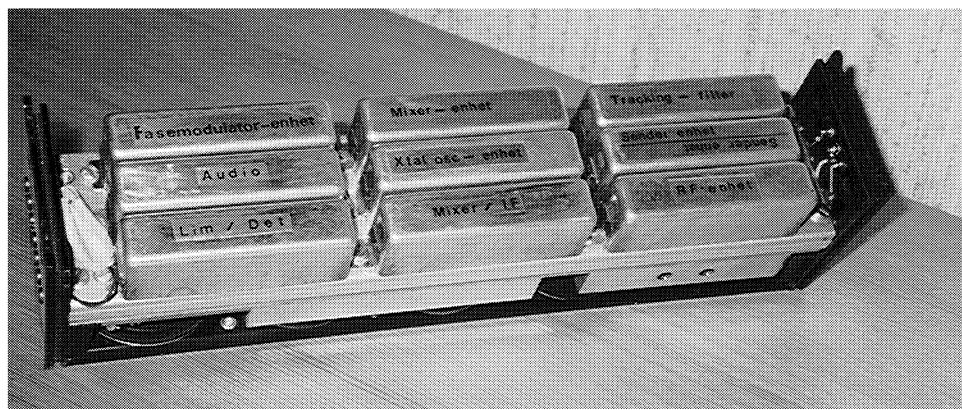
Feltradiosettet med modulene sett fra venstre: Fasemodulator-enhet, Mixer-enhet, Tracking-filter Audio, Xtal osc-enhet, Sender-enhet Lim / Det, Mixer / IF, RF-enhet
