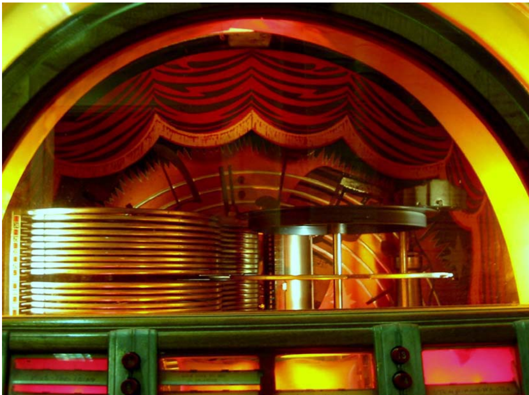
Spillemekanisme i Wurlitzer 1015
