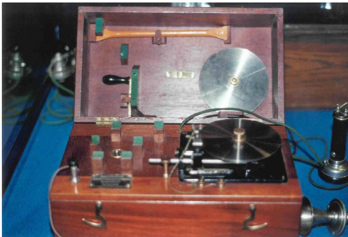
Foto 3. Viser Platetelegrafon fremstilt av Aktieselskapet Dansk Telegrafon, København. Dette er produksjonsnr. 121.
