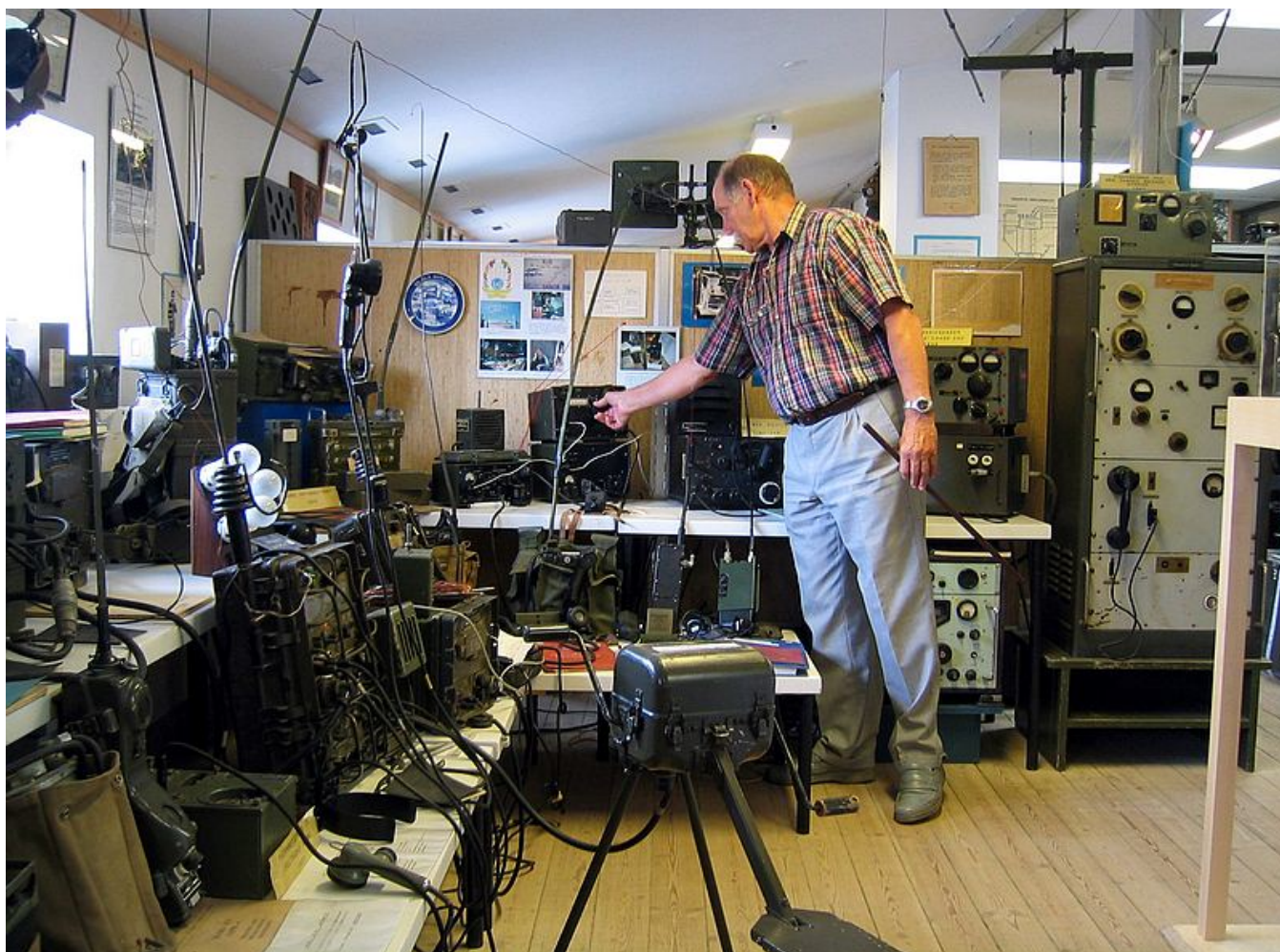
Rochler demonstrerer bærbare tranceivere. Helt i forgrunnen kan vi se Simondsen WT-2 som har betegnelsen - RADIO SET, INFANTERI, LIGHT PACK (INTERPLATOON) - SIMRAD WT-2 (1951).
