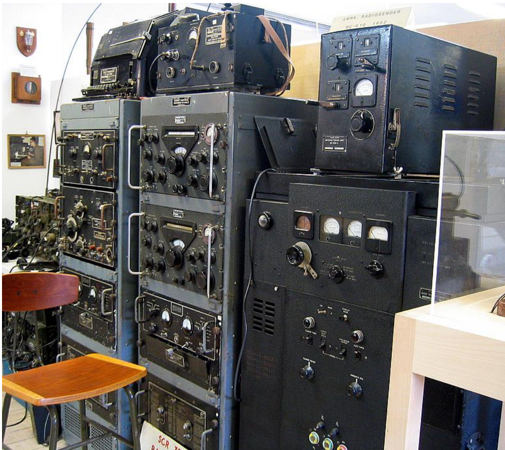
Tung feltradiostasjon for CW og fjernskriversamband, SCR399A. Med Collins R388/URR mottaker og BC610 sender. Denne stasjon inngår i AN/GRC26.
