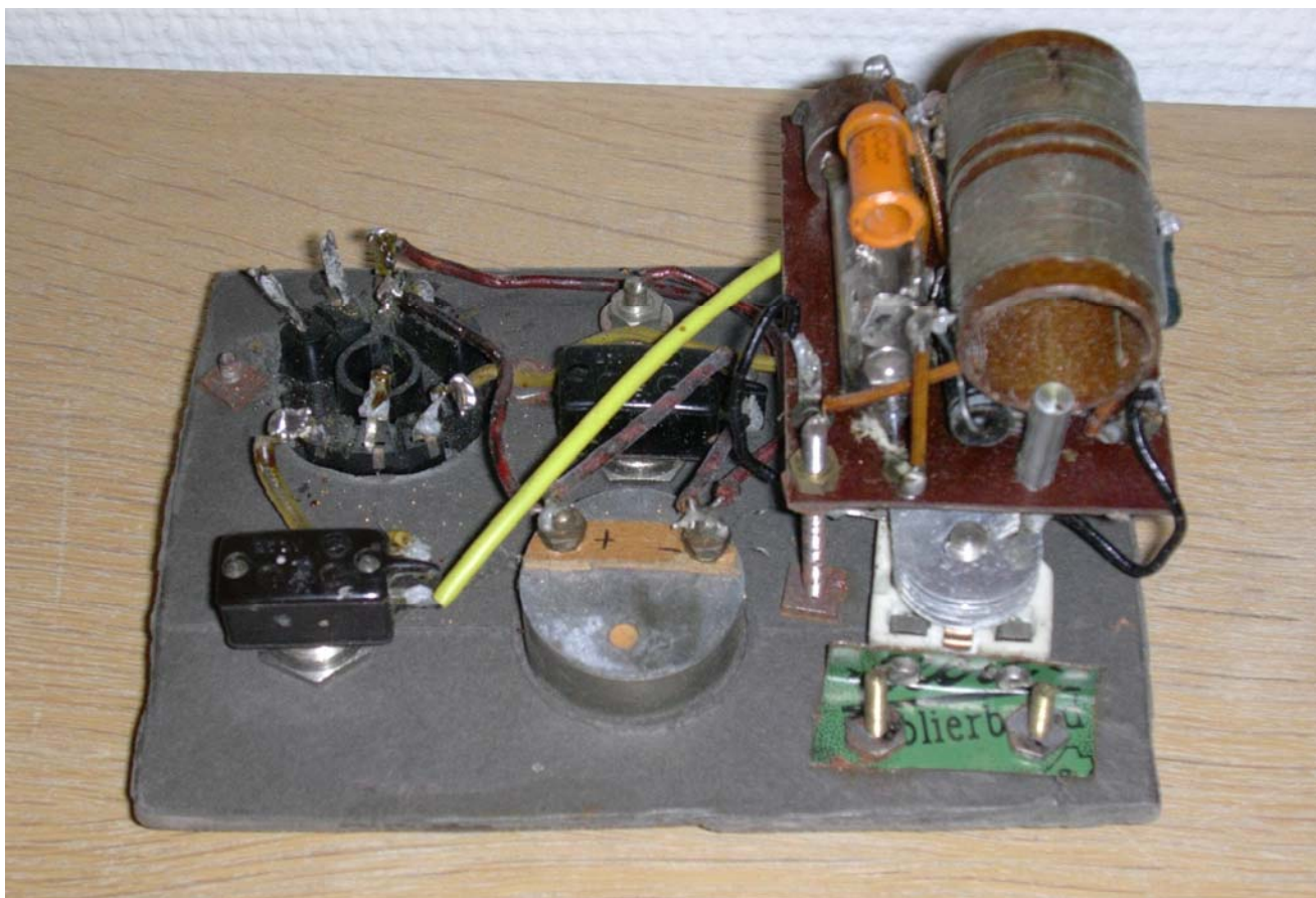
Syskrinet innvendig med tysk vær-radiosonde (Foto: Tore Moe)
