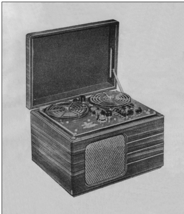
Båndopptaker fra 1940-tallet. Opptak på magnetisk papirstrimmel.
