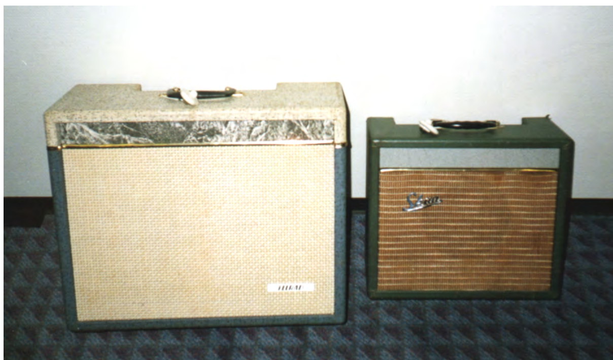
To forsterkere fra Telrad; en modell TGF 10/3E (E står for ekko, men forsterkeren var egentlig utstyrt med romklang) fra 1964, og en Skau TGF 5 fra 1962 (foto Bjørn H. Jensen)
