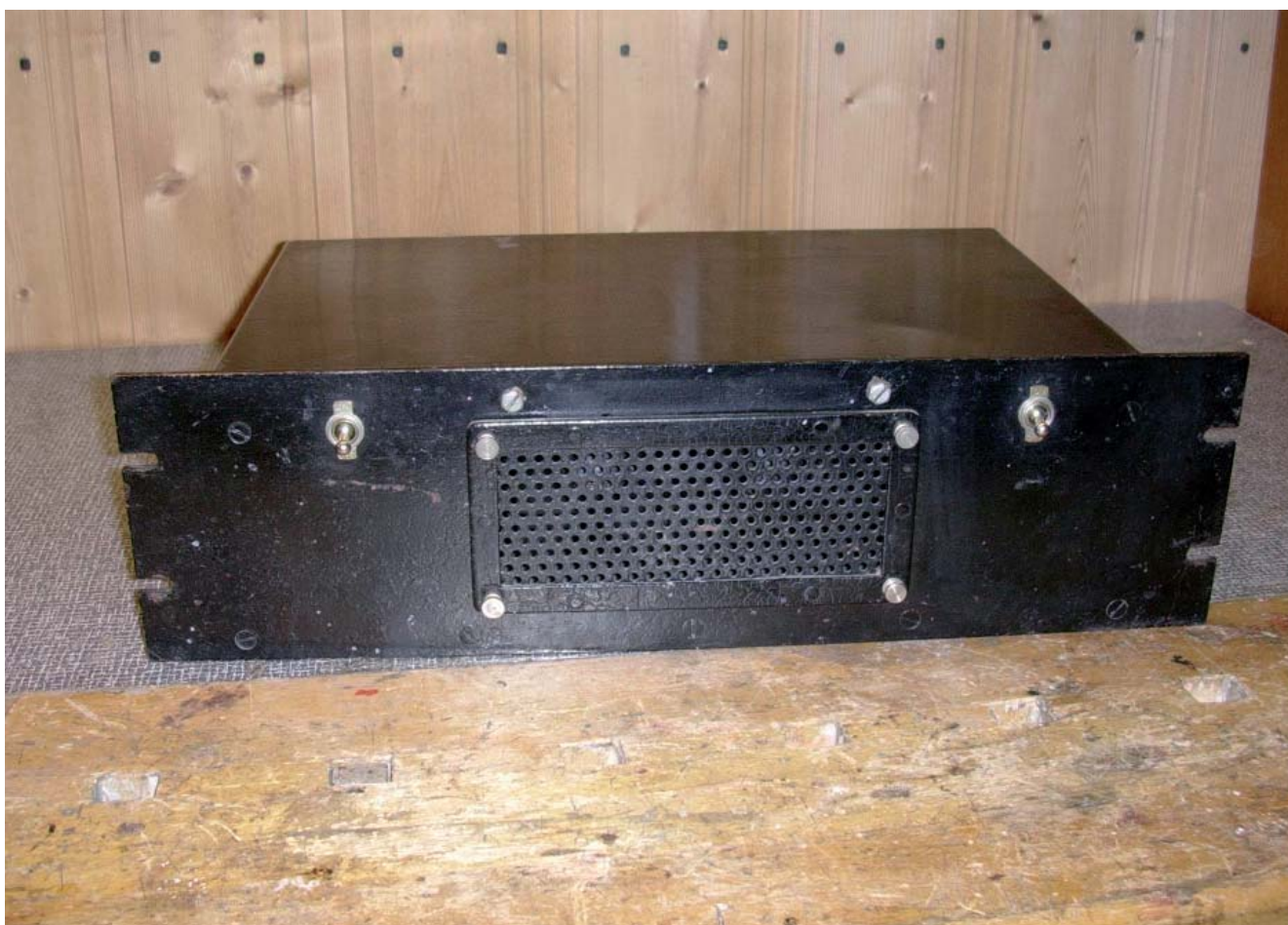
Dual Power Supply. Beregnet for å kunne kjøre to uavhengige HRO-mottakere samtidig.
