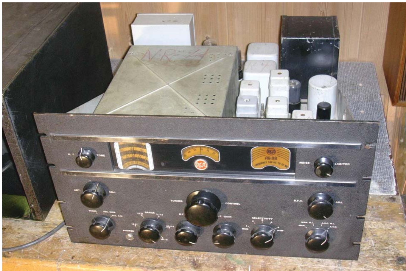
Chassiset dratt ut av kassa. Tuning-enheten til venstre er godt skjermet.
