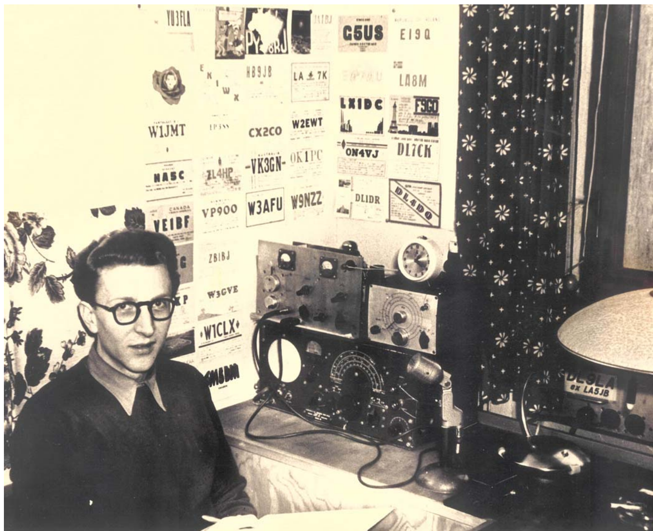
Tore Bremstad LA5JB på Hamar, som døde i februar i år, ved sin amatørstasjon ca. 1948. Stasjonen er en typisk etterkrigs stasjon. Vi ser en ombygget PCR-mottaker og hjemmelaget sender + VFO.
