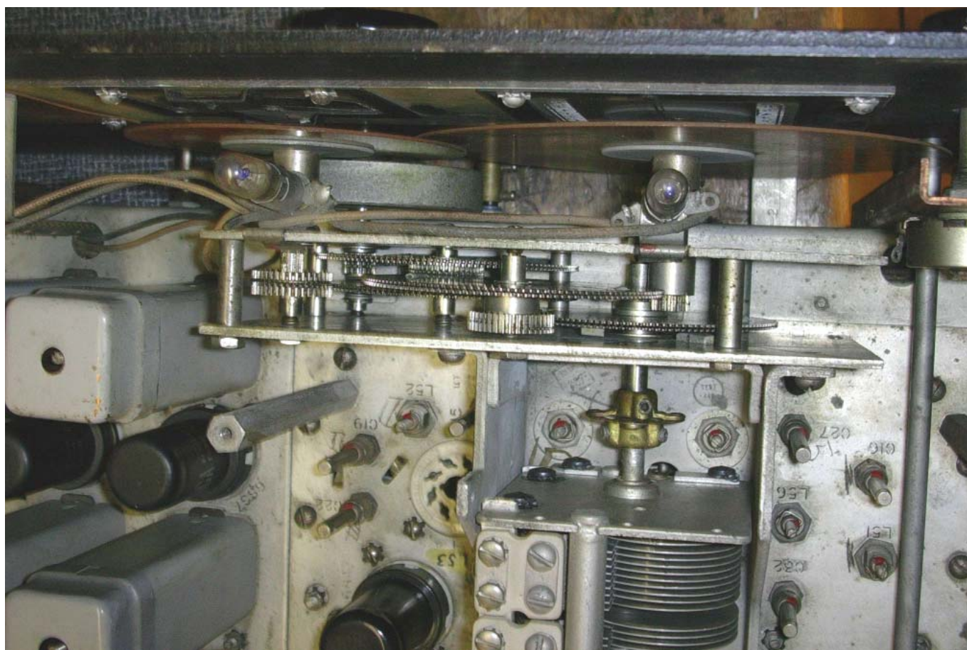
Nærbilde av avstemningsmekanismen. Denne er meget behagelig i bruk og fri for back-lash.
