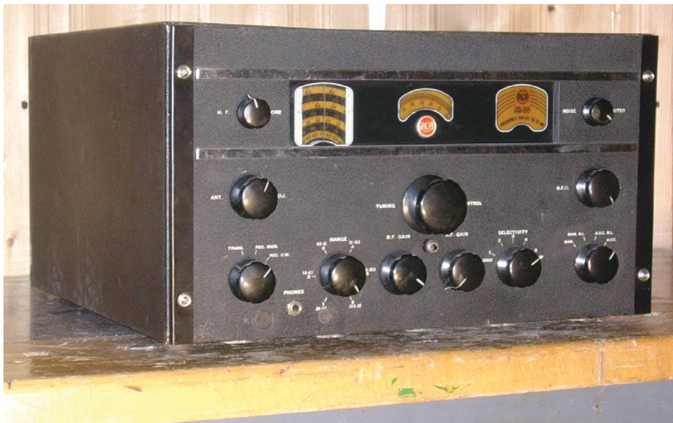
AR88D. Amerikansk kommunikasjonsmottaker laget av RCA under krigen. Slike var gjerne standardutrustningen for "Home Station" i England. Nesten hele produksjonen fra RCA gikk til England, derfor er disse sjeldne i USA.
