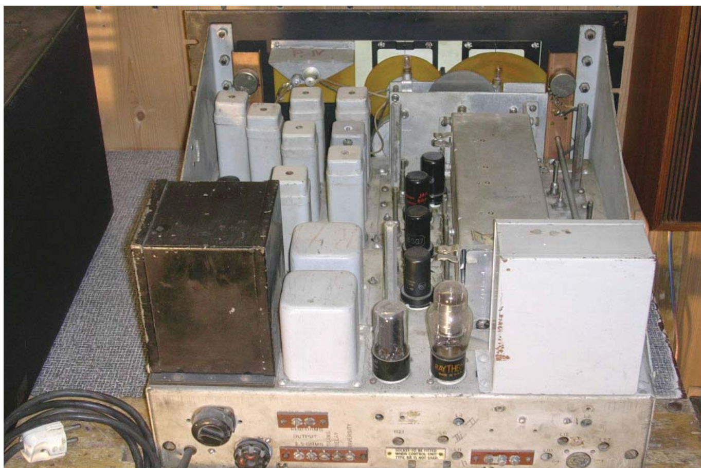
Chassiset sett bakfra. Her ser vi mange tunge komponenter. Hele radioen veier ca. 40 kg.
