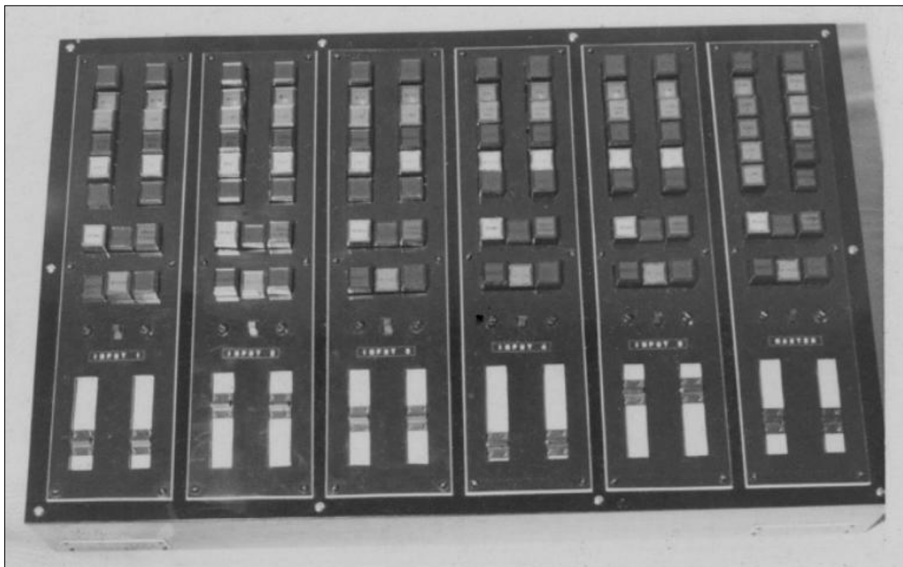
Stereo Multimixer. 12 kanals mixer. Programvalg over 108 trykk-knapper med indirekte belysning.
