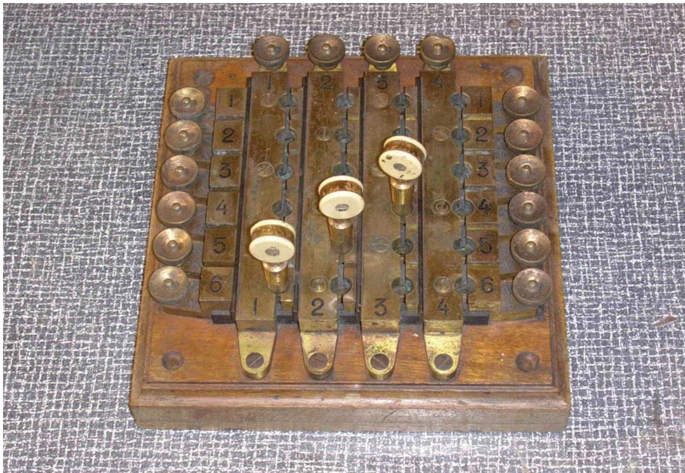
Krysskoblingsfelt for telegraflinjer, Siemens & Halske 1880.
