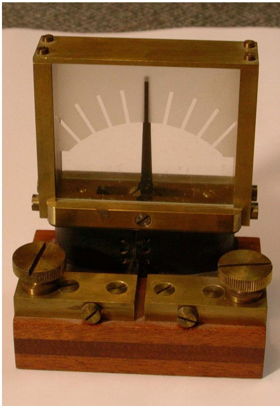
Telegrafgalvanometer fra Siemens & Halske, ca. 1880-90
