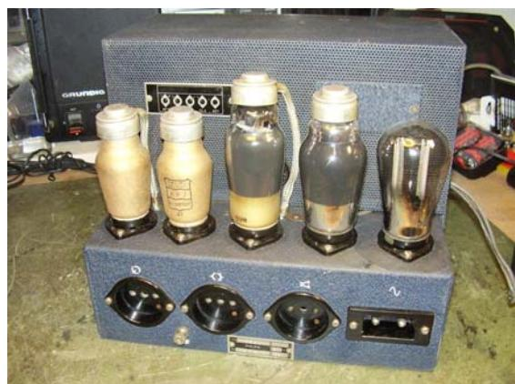
Sett bakfra. Denne forsterkeren er push-pull koplet med 2 stk CL 4 i utgangen og 2 stk AF 7 som forstørker rør. Tonekontrollen er noe spesiell; den består av en liten variabel glimmerkondensator, og har en fin regulering av tonen. Dette er absolutt en morsom forsterker.
