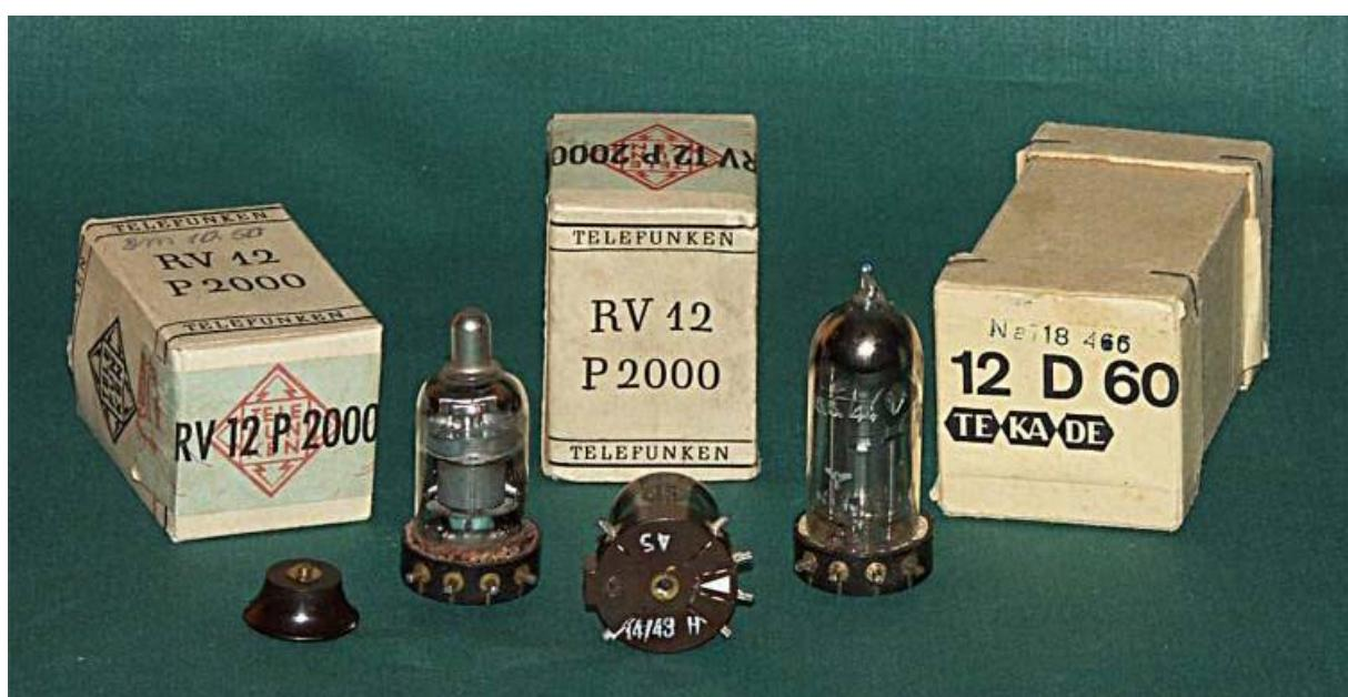
*Figur 5: Rör av typ RV12P2000 och 12D60 (likriktarrör)*
