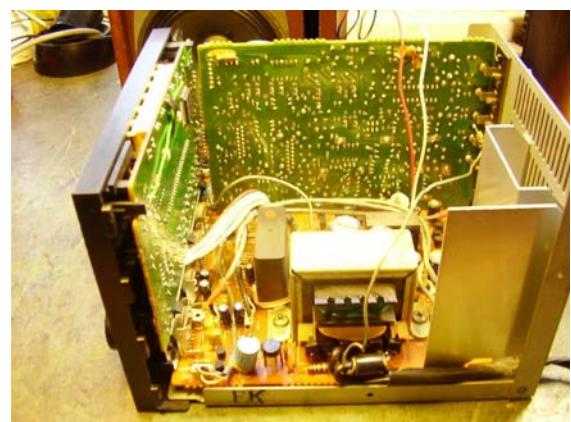
Som vi ser er det 3 printplater plugget i hverandre og med det vanlige Japanske virvaret av kabler og ledninger på kryss og tvers. Utgangen er en integrert stereo-blokk. Forfatteren sender etter en stor takk til Cato Nyborg for spennende bidrag til denne spalten. Fremtiden vil vise om dere setter pris på denne presentasjonen av forskjellige apparater, når mine kilder tørker inn. Da får vi håpe det er noen andre der ute som kan sende oss bidrag med apparater vi fortsatt ikke har møtt.
