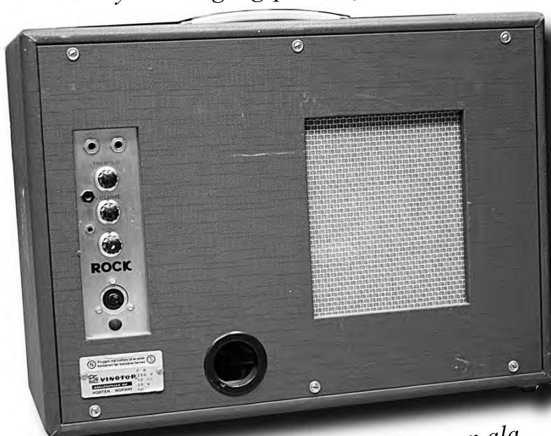
*Legg merke til hullet i bakveggen ala Tandberg for nettledning og som også virka som reflexåpning. Ubekjent kanskje?*
