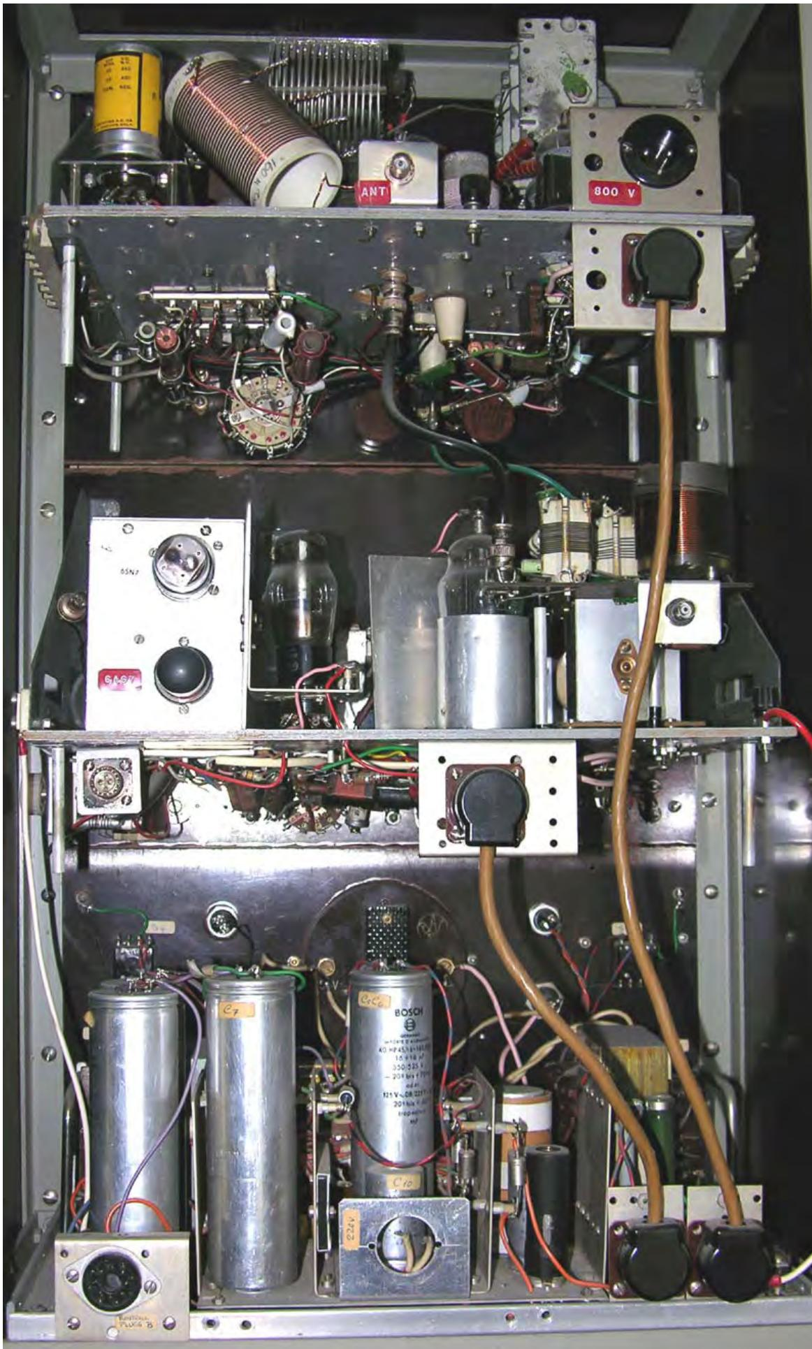
*Min første sender. Krystallstyrt oscillator med 6SN7.
