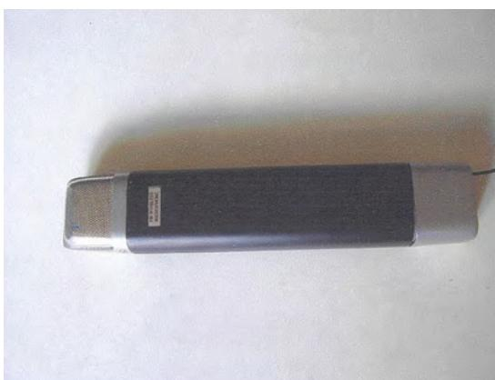
Dette er en trådløs mikrofon med innebygget FM sender som dekker det meste av FM båndet. Frekvensen er innstillbar ved hjelp av en trimmer som er tilgjengelig via et lite hull på baksiden. Senderen drives av et innebygget 9 volts batteri. Antenneledningen er 70 cm lang og stikker ut i bunn, hvor også av/på bryteren sitter. Jeg hadde engang i tiden to slike, og den ene ble solgt på auksjon. Jeg mener å huske at disse ble solgt av det amerikanske elektronikkfirmaet, Radio Shack.
