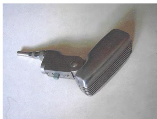
Dette er en artistmikrofon beregnet til å stå på et stativ. Pluggen i bunn er en tre-polet mikrofonkontakt av den japanske typen. Denne mikrofonen har typebetegnelse DM-20, og impedansen er på 50 kOhm.
