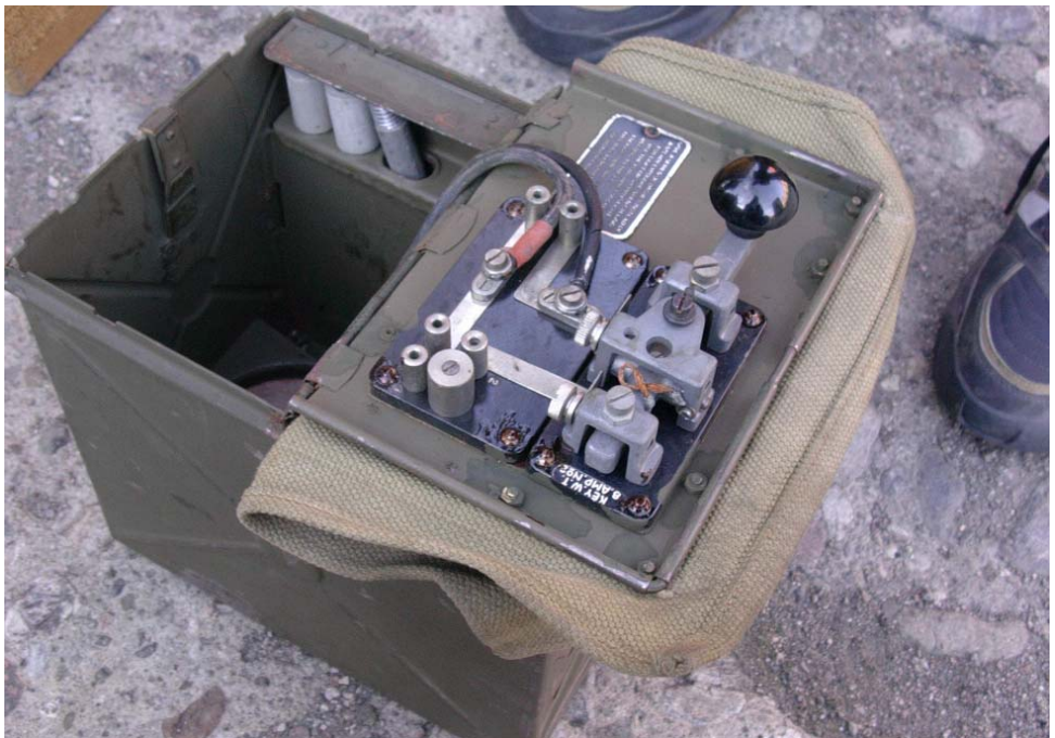
Boks med morsenøkkel til signallampa
