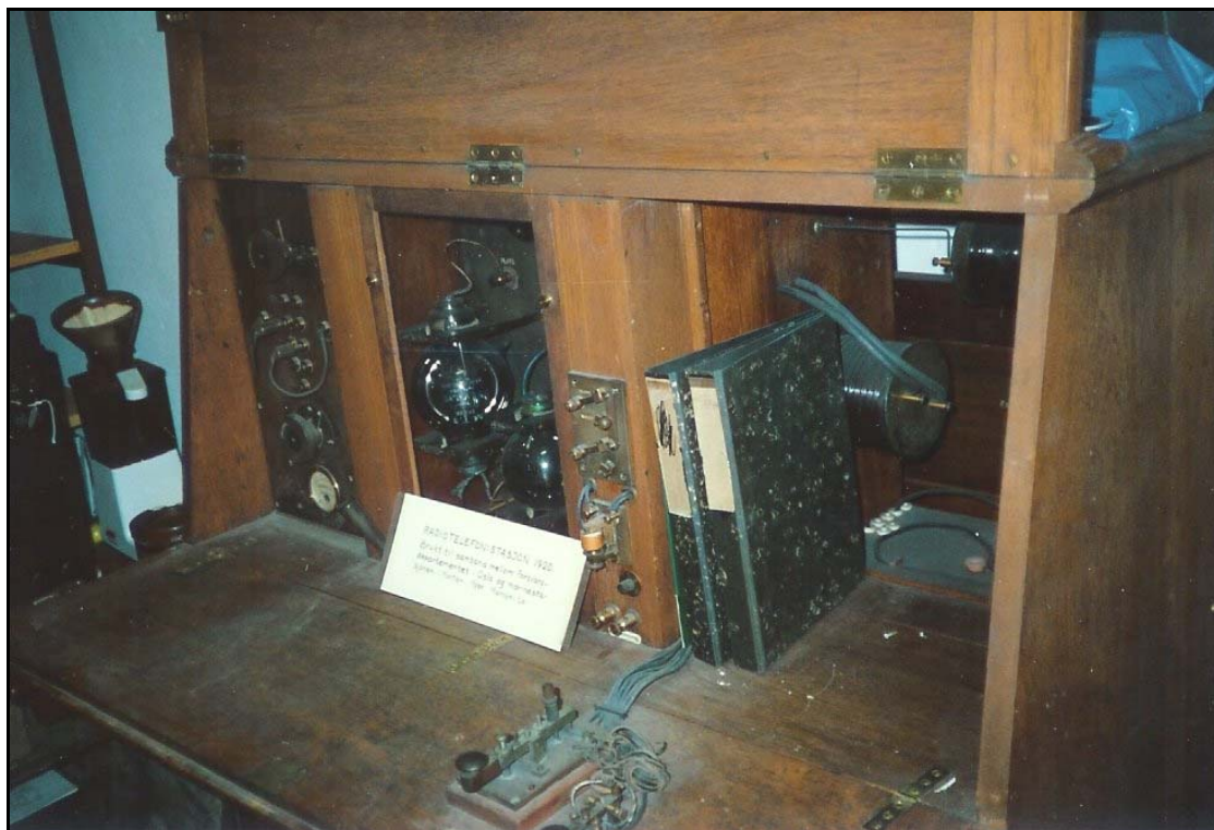
Her ser vi Forsvarets Marconi stasjon fra 1920, bygget som et skrivebord, og vi ser sender-rørene som er et par ordentlige flasker.
