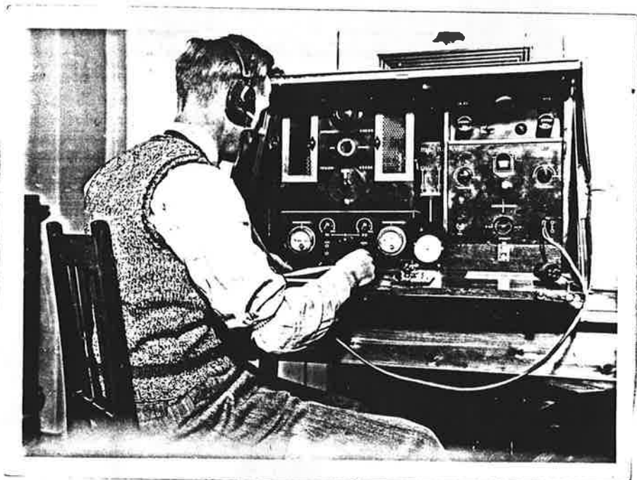
1932, Hvalsmoen. 200 W kortbølgesender og mottager. Semiportable, benyttet av ing.våpnet. (LA3W operating)
